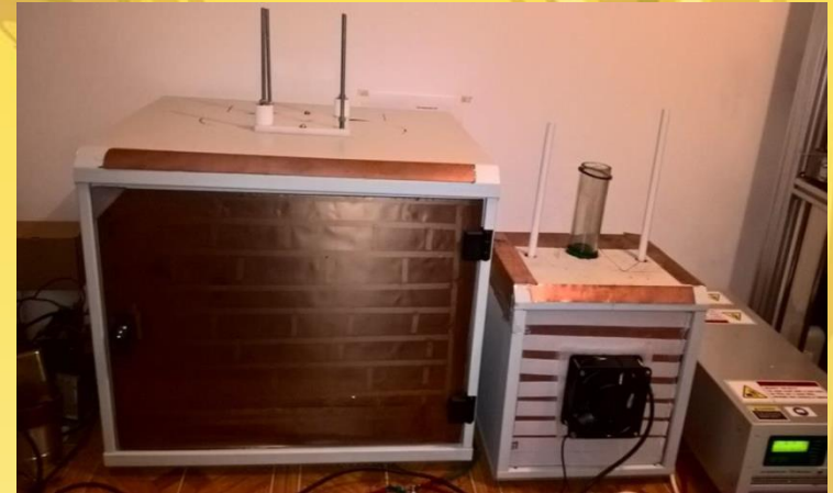
Tratarea probelor cu RF 75°C/ 85°C
